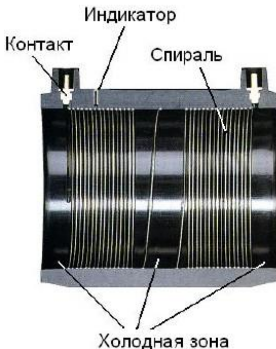
Рис.4.17. Муфта с закладным нагревателем
