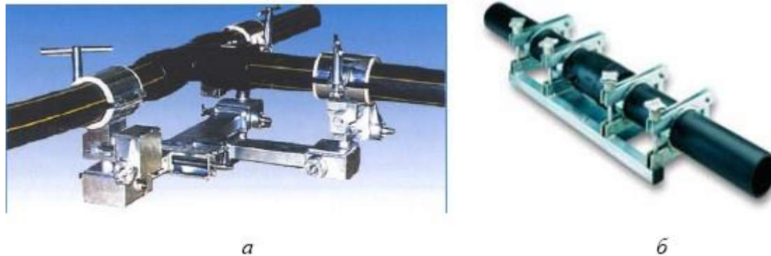
Рис.4.22. Позиционеры: а – тройной; б - двойной
