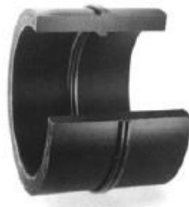
Рис. 4.14. Стыковой шов с наружным и внутренним гратом
